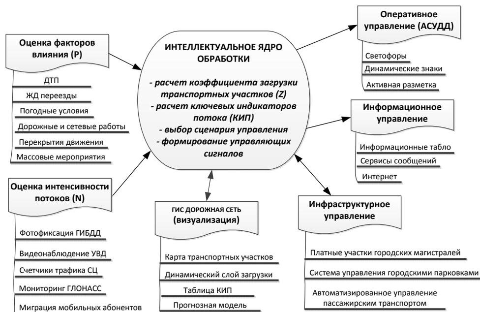
Рис. 1. Архитектура интеллектуальной системы управления дорожно-транспортным комплексом
